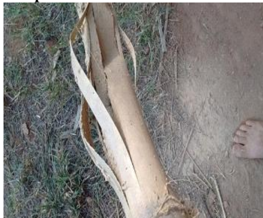
Figura 15 – Apodrecimento do bambu e sua deterioração
