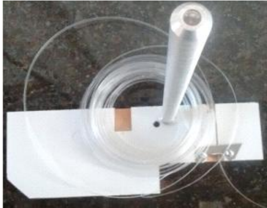
Figura 3 – A máquina e os fios de garrafa PET produzidos por ela
