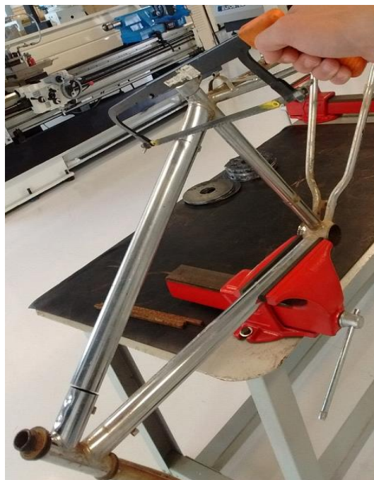
Figura 10 – Fotografia do início do procedimento para substituição das peças tubulares metálicas pelas peças de bambus tratadas
