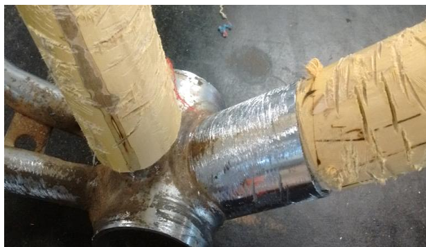
Figura 12 – Superfície dos materiais ligantes bambu e metal após os procedimentos com a serra
