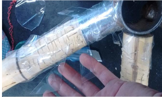
Figura 13 – Disposição da placa de plástico antes de ser amarrada com fio de PET
