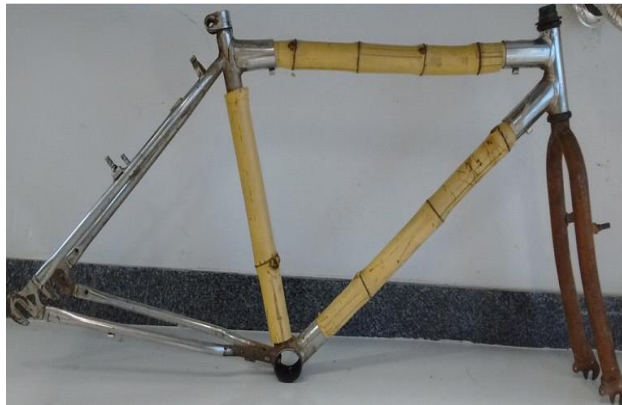
Figura 11 – Quadro da bicicleta com as peças de bambu já encaixadas no local
